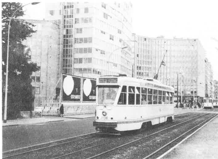
De opname toont ons PCC 7136.103 op de Sterrekundelaan, en rijdend naar Jette, Kardinaal Mercierplein. Op dat ogenblik reden alle MIVB-trams nog met trolley-stang als stroomafnemer. Wo.24 apr.68, Foto Eigen Baan.
